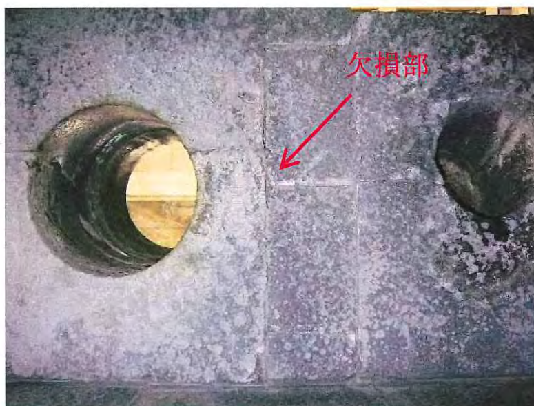
(平成 22 年 3 月実施の炉内観察時の該当部 (打音検査のため付着物を除去した後の様子))
