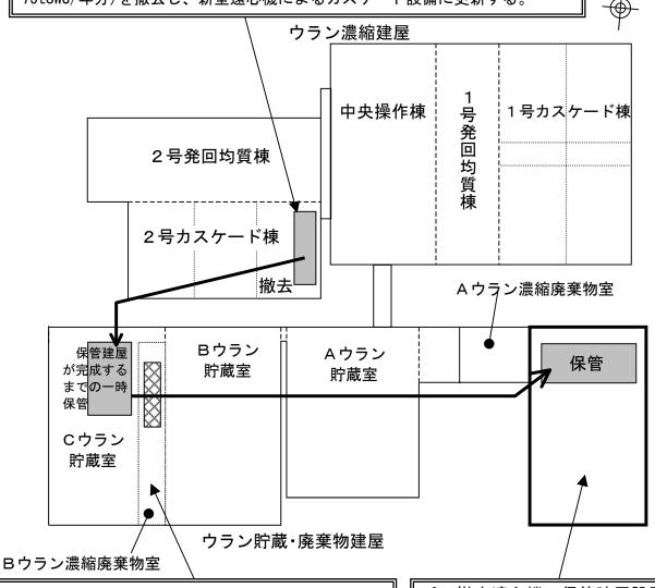
3. 既設Bウラン濃縮廃棄物室の保管能力増強 既設Bウラン貯蔵・廃棄物建屋内の空きスペースの利 用等により放射性固体廃棄物の保管能力を増強する。 2. 撤去遠心機の保管建屋設置 撤去した既設遠心機等を保管するため の建屋を設置する。
