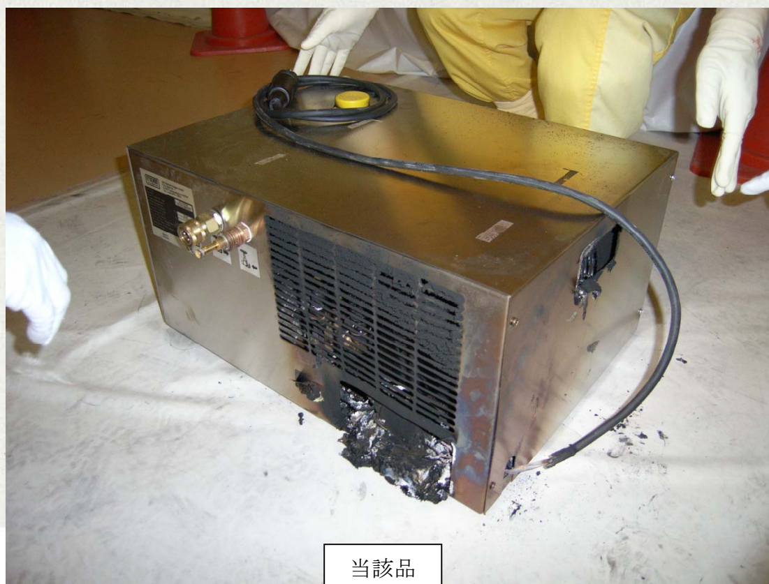
事象発生前後の冷却水循環装置
