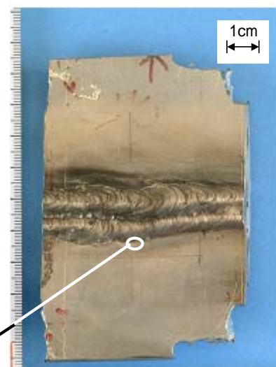
貫通欠陥2試験片 表面写真
