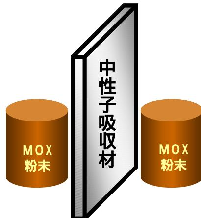
核分裂連鎖反応を引き起こす中性子を吸収し、臨界を起こりにくくする材質を用いて、MOX粉末を取り扱います。
