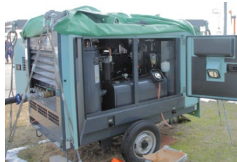
可搬型空気圧縮機
