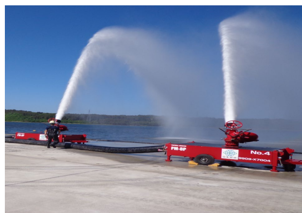
可搬型放水砲（放水訓練の様子）
