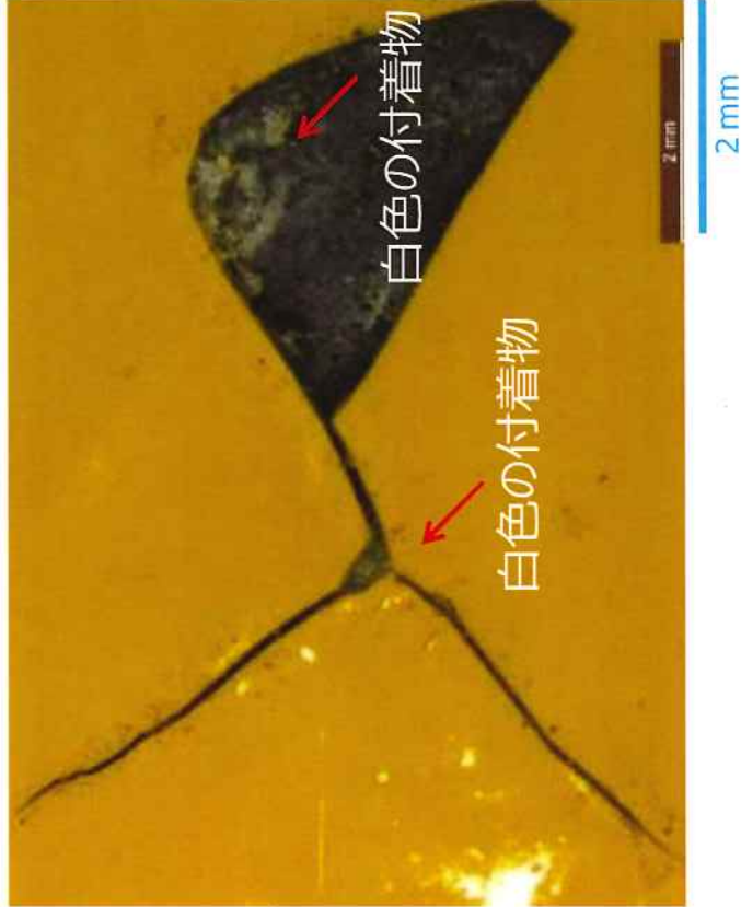
ドラム缶底部剥がれ箇所を正面から撮影
