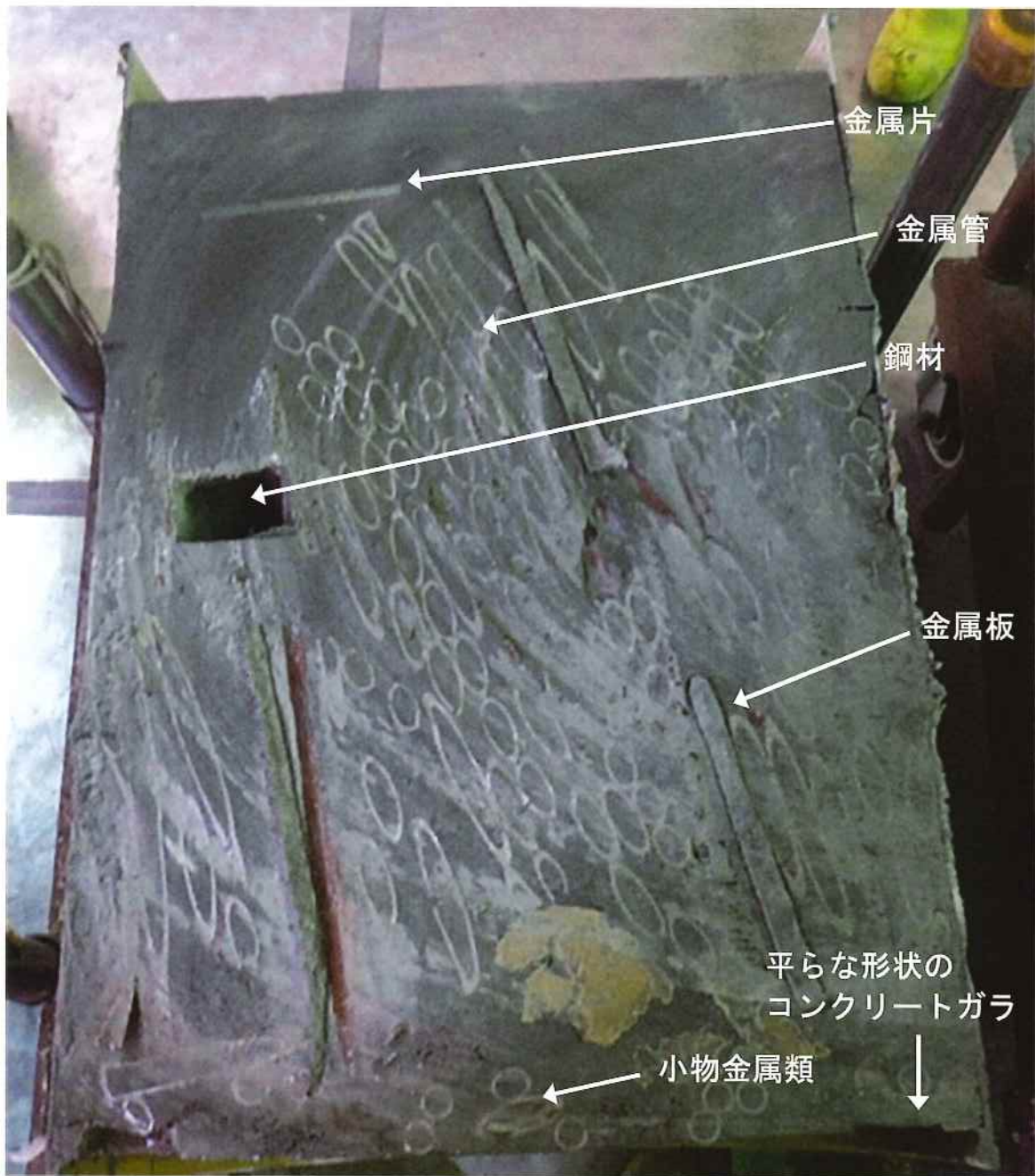
水滴が確認された廃棄体の収納状況 (3 本目) (整理番号: 1740062-CB1L)
