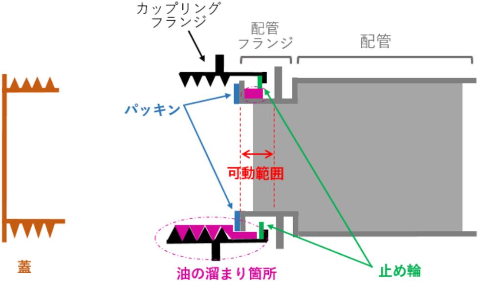
蓋を閉め込むことでカップリングフランジが蓋方向（右図左側）へ可動し、配管側のフランジに押しつけられることで密着となる。
