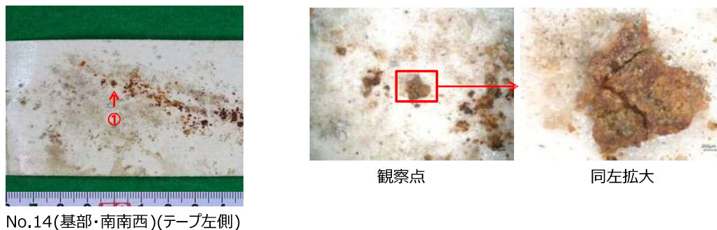
図-49 位置決め部材 No. 14 (基部・南南西) サンプル表面のデジタルマイクロスコープ拡大像
