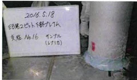
図- 57 レプリカ作業状況 (位置決め部材 No. 16)
