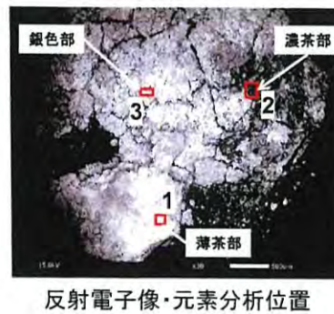
図- 37 下部プレナム形成板 サンプル表面のSEM-EDS 反射電子像 (BEC) (No. 26)
