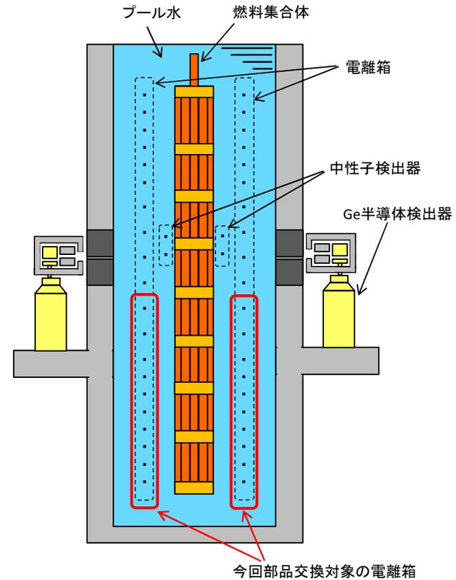
燃焼度計測装置の概略図
