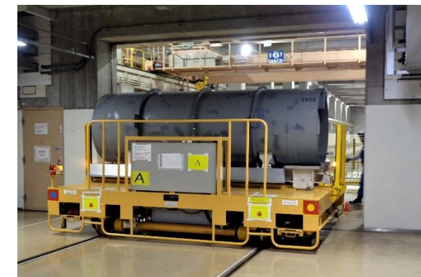
ウラン貯蔵室から発生槽へ移動する様子
