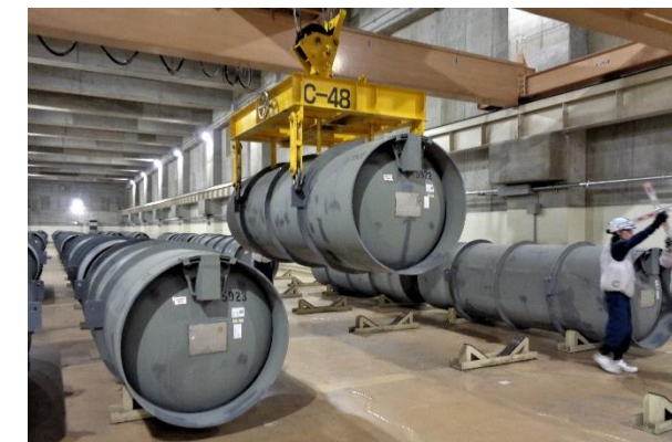
原料シリンダをクレーンで吊り上げる様子
