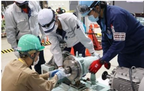
地元企業の方々がポンプの分解点検の訓練を受ける様子
