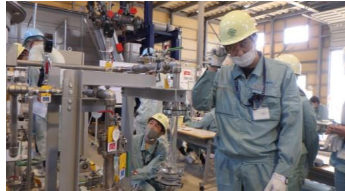
聴診棒を使った異音・振動の確認
