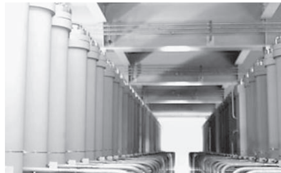
複数の遠心分離機が設置されているカスケード室
