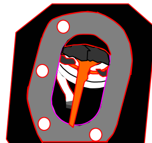
流下ノズルの外側からも断続的に流下するケース
