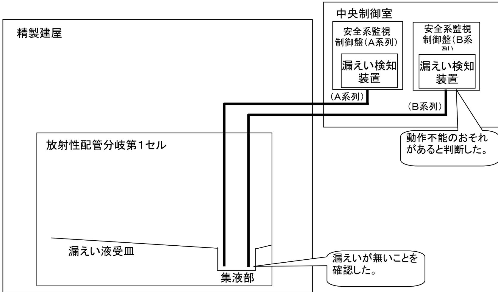
セル内漏えい検知装置概要図
