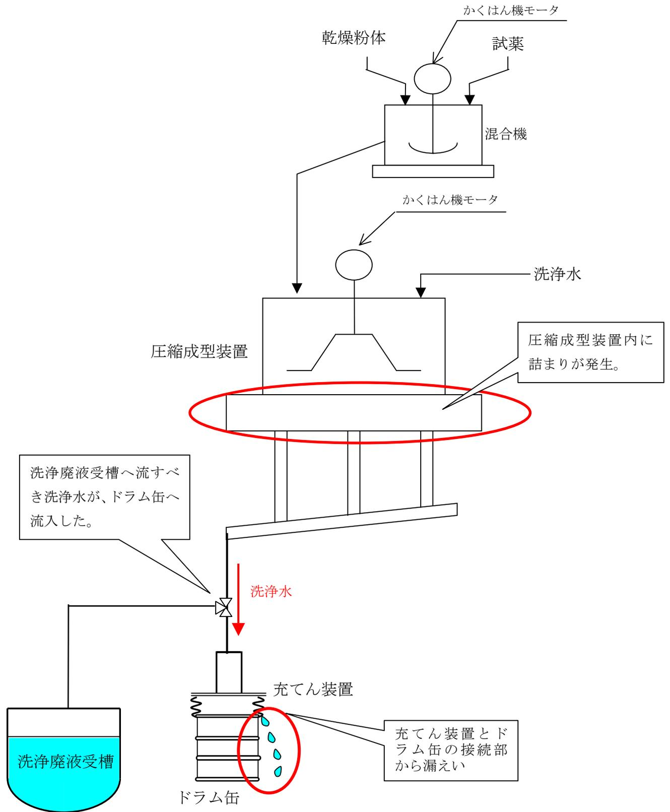
低レベル濃縮廃液処理系造粒工程 概要図
