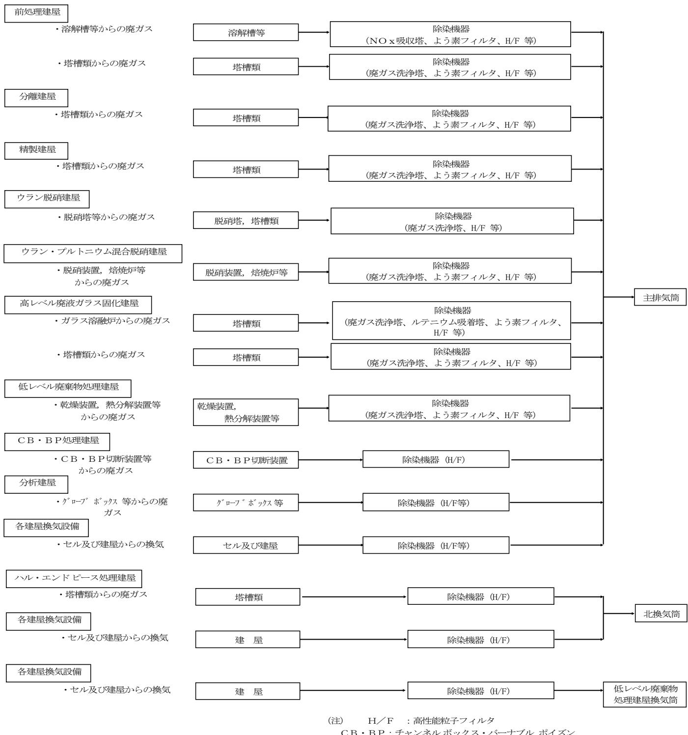
図-5 気体廃棄物の処理系統図
