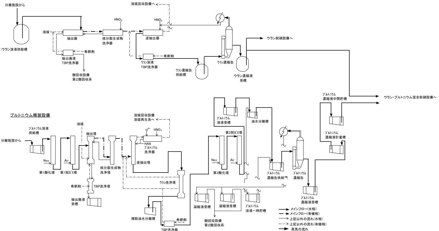
図-3 精製施設の試験における溶解液等の主な流れ
