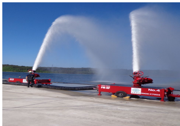
可搬型放水砲（放水訓練の様子）
