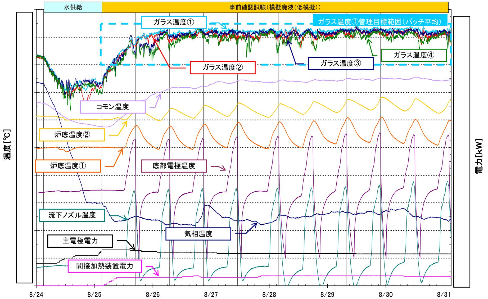
図一Ⅲ. 1. 2. 1 A系列事前確認試験(模擬廃液(低模擬)による確認)でのガラス温度等の推移
