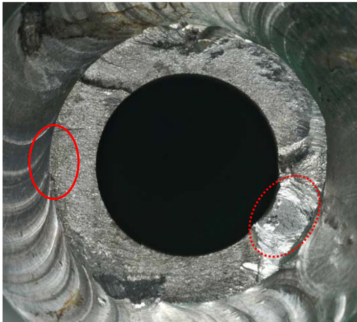
パイプチューブアダプター側の破面状況
