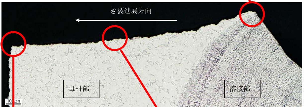
パイプチューブアダプター側の 断面組織観察位置
