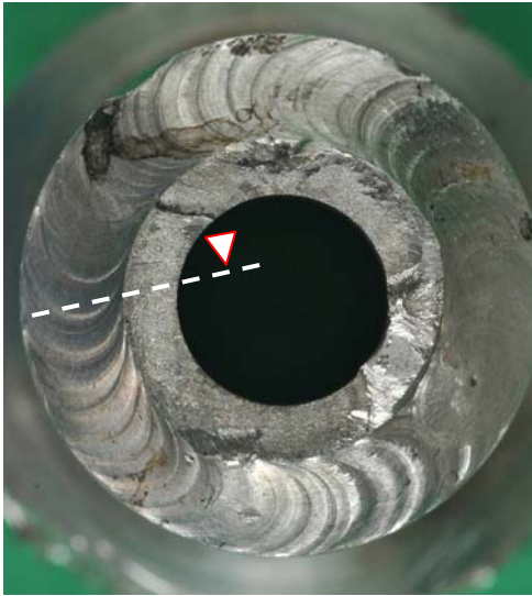
パイプチューブアダプター側の 断面組織観察位置
