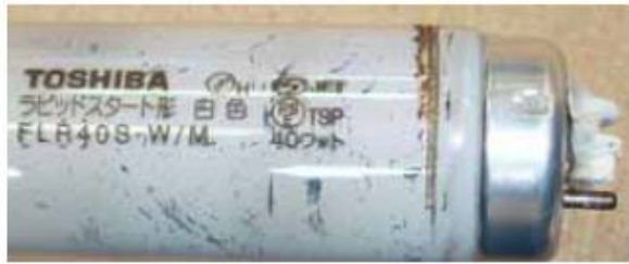
ソケット溶融損傷側
