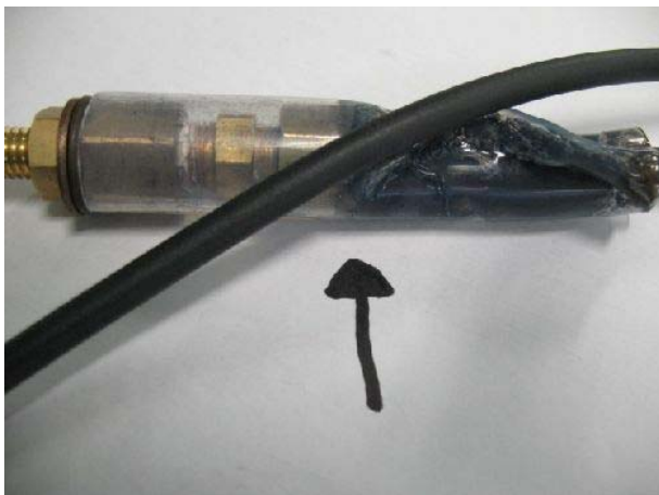
写真4 イグナイターケーブル放電痕とチューブカバー貫通孔の位置関係
