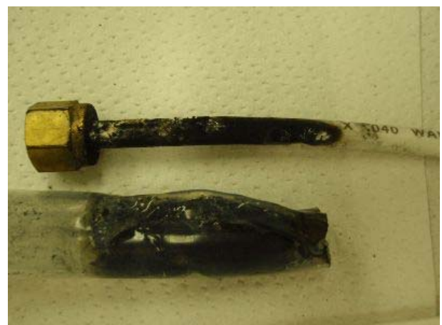
ICP-MS 冷却水循環チューブ及びチューブカバーの状況写真
