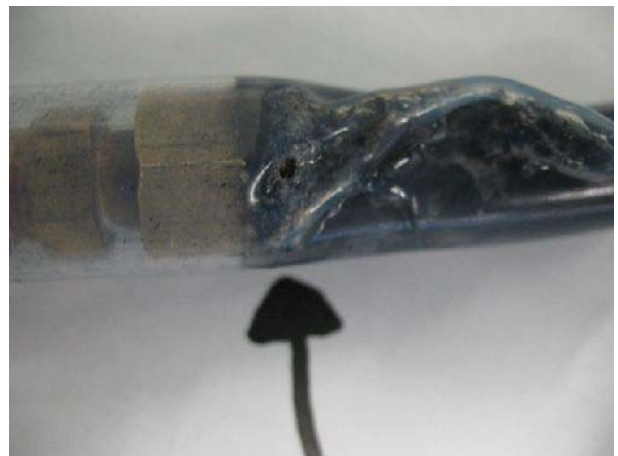
写真4 イグナイターケーブル放電痕とチューブカバー貫通孔の位置関係
