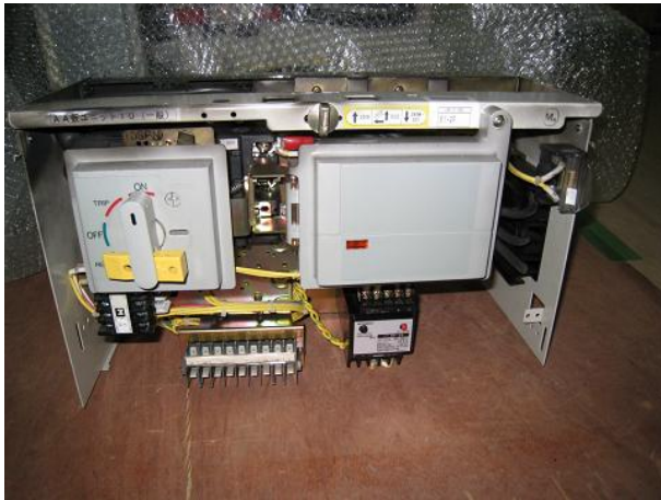
仮設電源ユニット 前面
