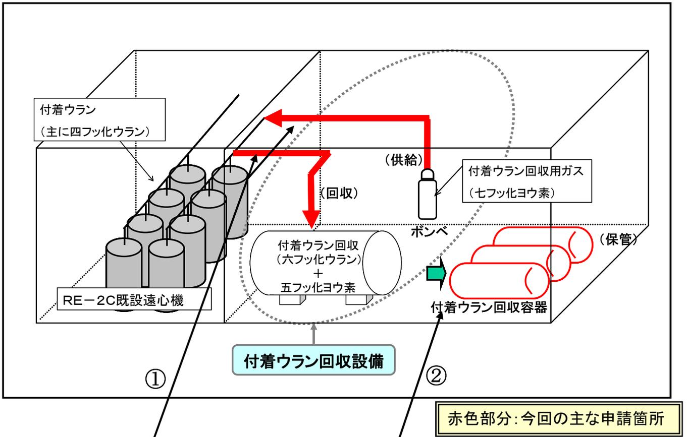
六ヶ所ウラン濃縮工場において、RE-2A の既設遠心機内に付着しているウランの回収作業に引き続き、RE-2C の既設遠心機内に付着しているウランを回収するために、以下の工事を行う。
