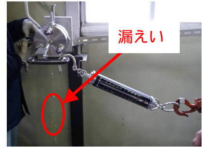
外荷重を掛けて漏えい有り
