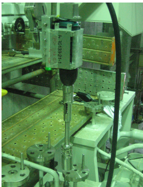
インパクトレンチ締め付け(垂直方向: 締め付けトルク確認を模擬)
