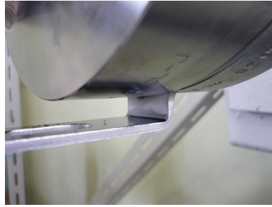
外荷重無し状態で漏えい無し
