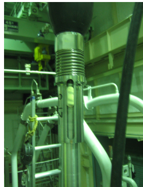
インパクトレンチ締め付け(垂直方向: 締め付けトルク確認を模擬)
