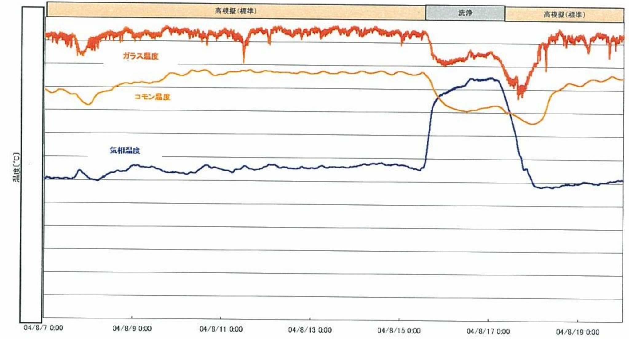
ガラス温度、気相温度等の推移（モックアップ試験）
