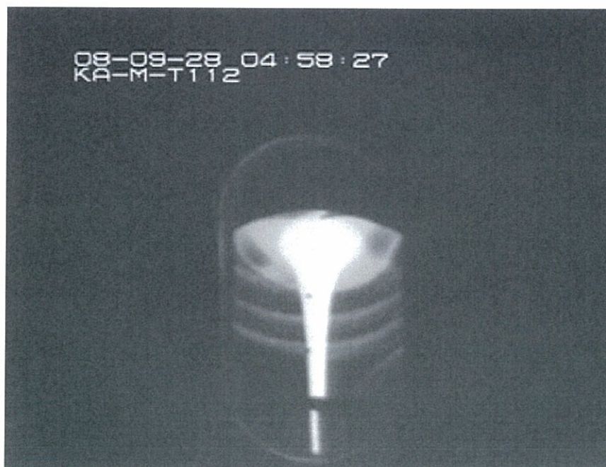
I T V で直視した覗き窓映像 (流下ノズル健全性及び流下性確認試験時) (視認性が向上している)
