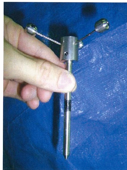
ノッカー装置先端治具
