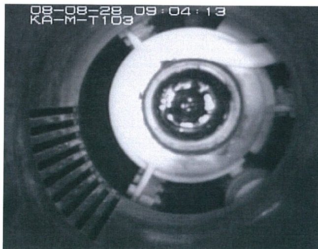
流下ノズル下端周辺の付着ガラス等の除去結果
