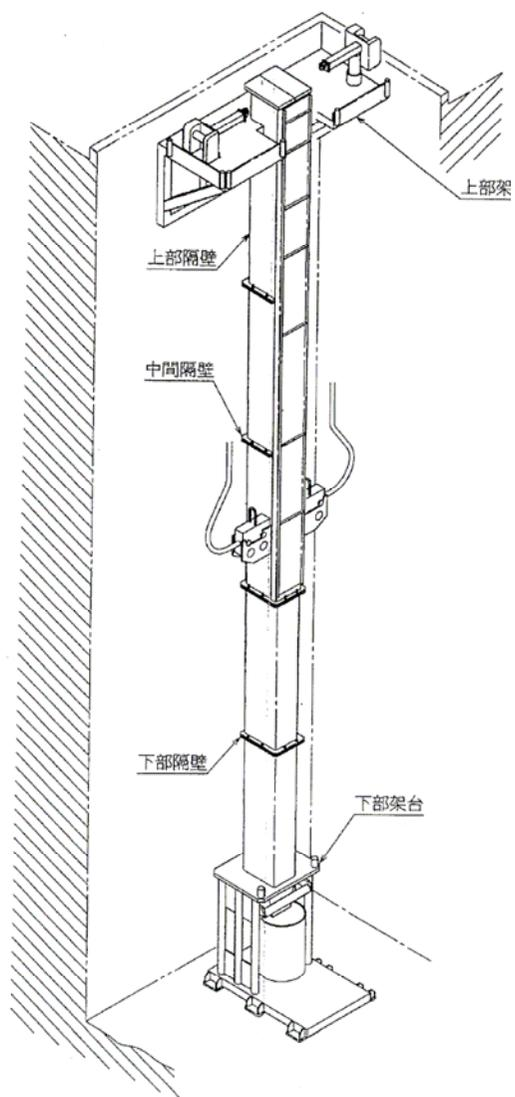
第1チャンネルボックス切断装置概要図
