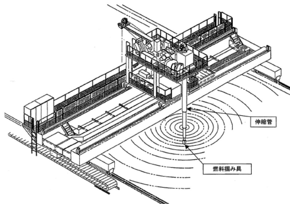
燃料取扱装置概要図
