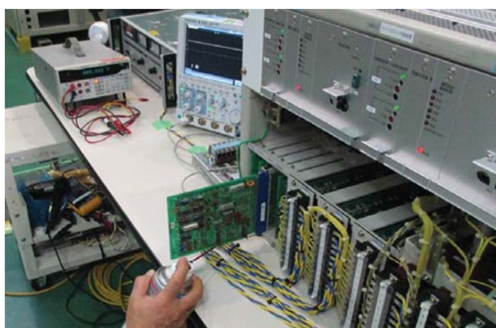
図-4 (2) 工場試験状況 (急冷試験)
