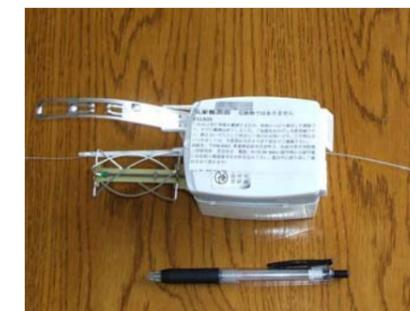
図2(1) ラジオゾンデ (観測センサー、バッテリー等)
