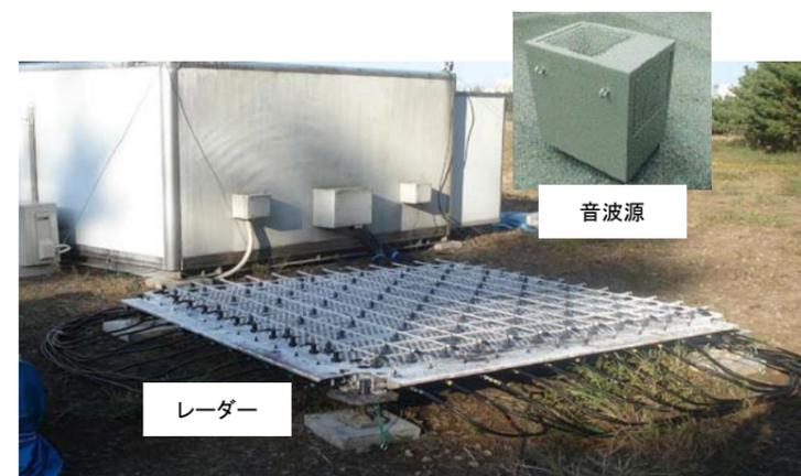
図1(2) ウィンドプロファイラー/RASS
