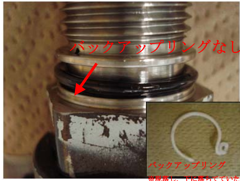
フィルタ差圧計取付け部調査結果 (バックアップリング脱落状況)
