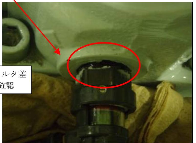
せん断機B油圧制御ユニット油漏れ箇所
