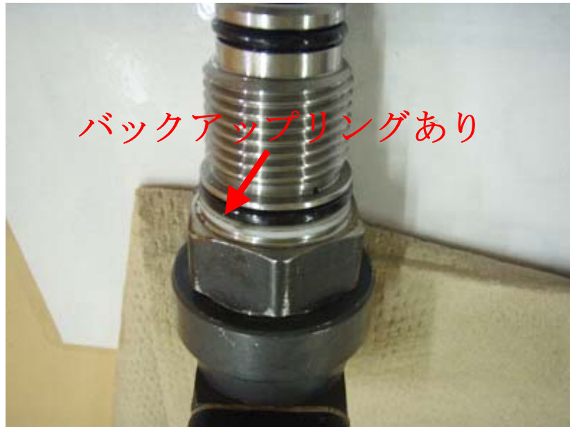
フィルタ差圧計取付け部調査結果 (バックアップリング脱落状況)
