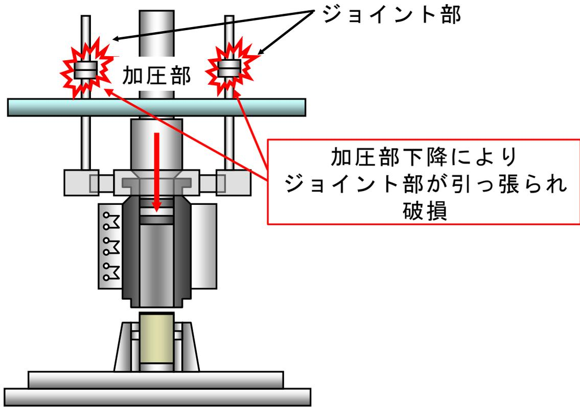
圧縮成型装置 概要図
