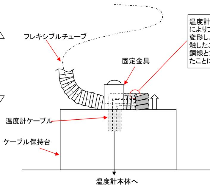
温度計昇降動作時のケーブルの動きによりフレキシブルチューブ末端部が変形し、当該末端部とケーブルが接触したことで被覆が損傷し、露出した銅線とフレキシブルチューブが接触したことにより絶縁不良が発生した。
