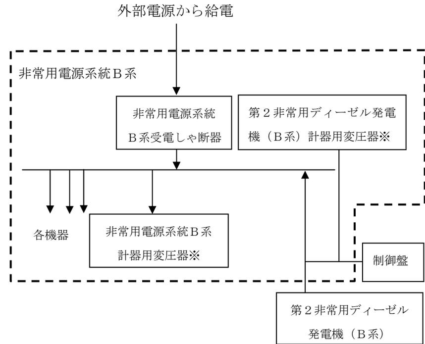
※：高電圧を計器で測定できるように低電圧に変圧する装置
